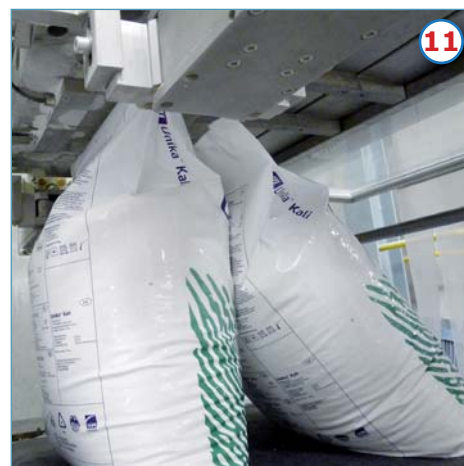
9 Nastro sbattitore per compattamento prodotto all'interno del sacco - Shaking belt for product squaring inside the bag - Tapis mélangeur pour compactage produit à l'intérieur du sac
