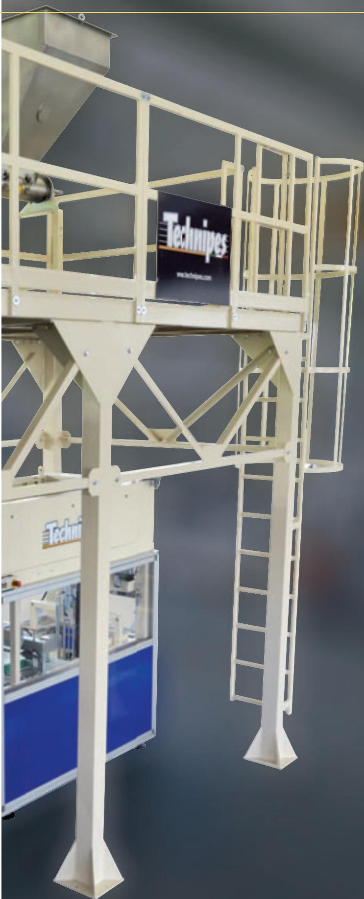
**ADVANTA**® rappresenta un'ulteriore evoluzione tecnologica delle stazioni d'insacco completamente automatiche, per sacchi preformato del tipo a soffiato, a bocca aperta.
