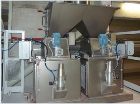
Pesatrici in versione completamente INOX 304 Weigh scales manufactured entirely in stainless steel 304 Doseuses pondérales en version complètement en acier inoxydable 304 Balanzas fabricadas totalmente en acero INOX 304.
